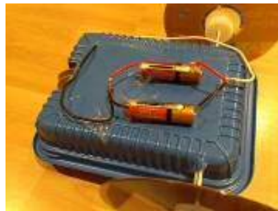
Fils montés dans un circuit en parallèle
