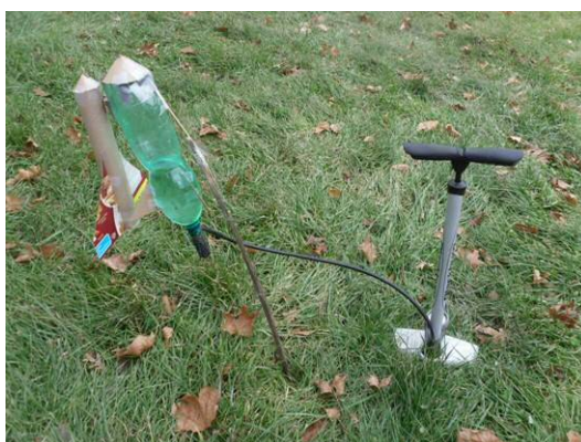
Assemblage de la fusée bouteille avec la valve insérée dans la navette.
