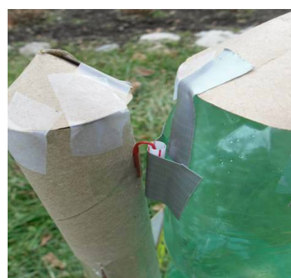
Assemblage de la fusée bouteille avec la valve insérée dans la navette.
